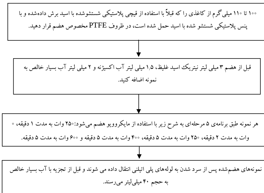
شکل ۱-۲. روش استفاده‌شده برای هضم نمونه‌های کاغذ با استفاده از مایکروویو [۱].
