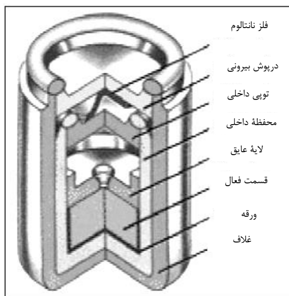
شکل ۱۱-۳. ژنراتور گرمایی پرتوزا حاوی ^{238}\text{Pu} .
