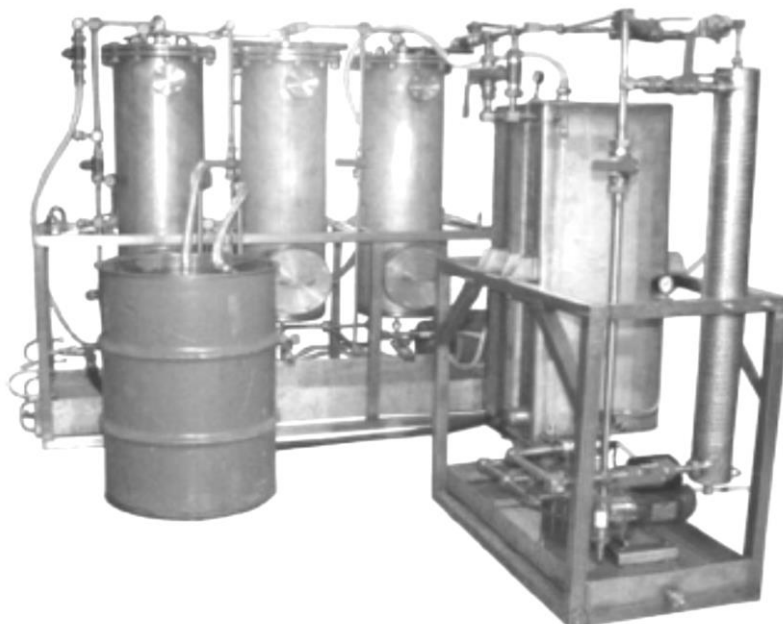
شکل ۱۴-۷. یک واحد نمونه دستگاه آمایش آب سیار. با اجازه وای. کارلین ۱ ، سیا رادون، روسیه.
