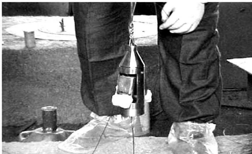
شکل ۱۲-۶. کیت تست آلودگی برای کانال‌های بارگذاری پسمان‌گور.
