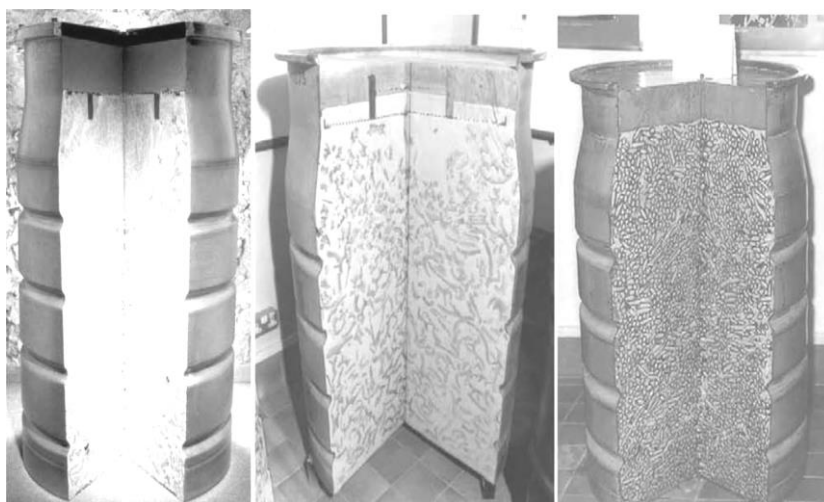
شکل ۹-۱۵. پسماند با پرتوایی سطح متوسط به فرم جامد، مایع و دوغاب محصور شده در سیمان در بشکه‌های ۵۰۰ لیتری. اهداء BNFL.
