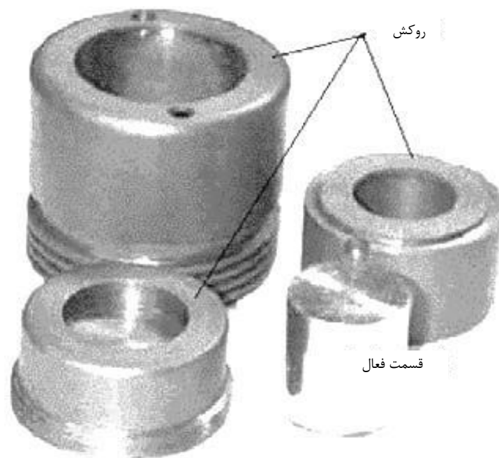
شکل ۱۰-۲. چشمه‌های پرتوزای تجاری بسته ^{60}\text{Co} مورد استفاده در صنعت و پزشکی.
