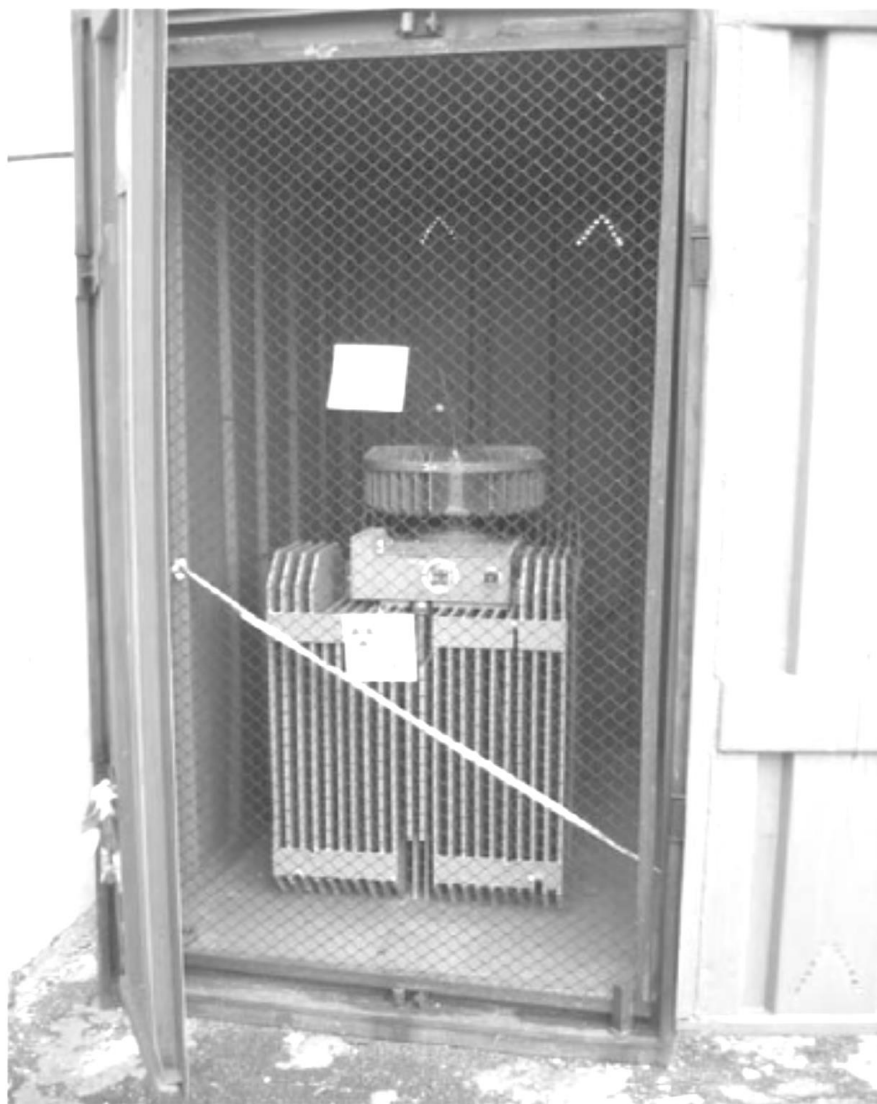
شکل ۱۰-۳. نمایی از یک مولد ترموالکتریک رادیوایزوتوپی مصرف شده در یک مخزن انتقال.
